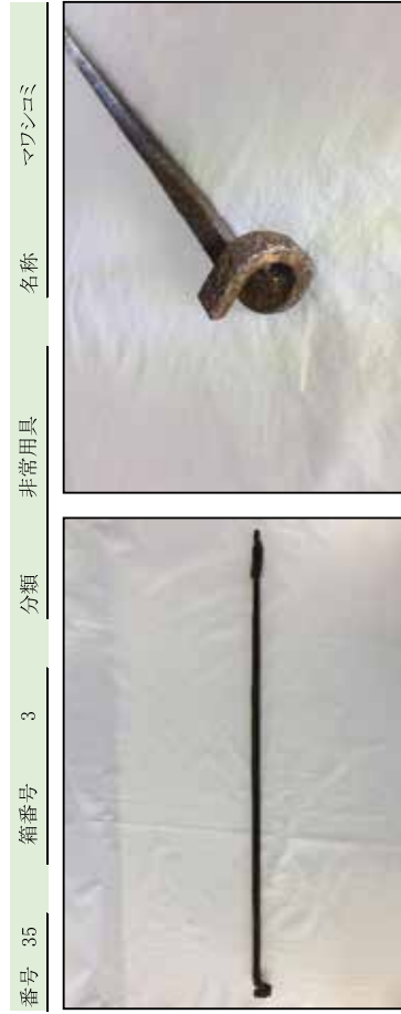
寸法 長さ77.9cm、先端部外側2.7cm×2.8cm、先端部内側1.8cm 材質 鉄製 重量 708 g 備考 孔中に落ちた道具を、まわし込みながらヒゴをつかみこんで引き上げる
