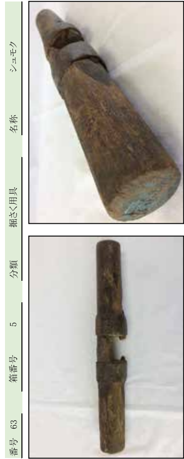
寸法 全長32.8cm、軸幅4.1cm 材質 木製・鉄製 重量 426 g 備考 「斉藤」焼印あり、鉄管の突き下ろしの手掛かりとなる1人用のシュモク
