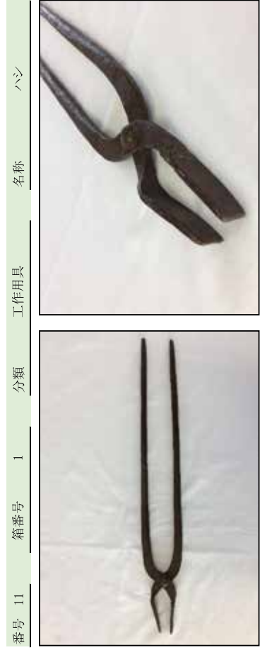
寸法 長さ50.2cm 材質 鉄製 重量 770 g 備考 鍛冶作業の時に、焼けた鉄などの金属を挟む道具
