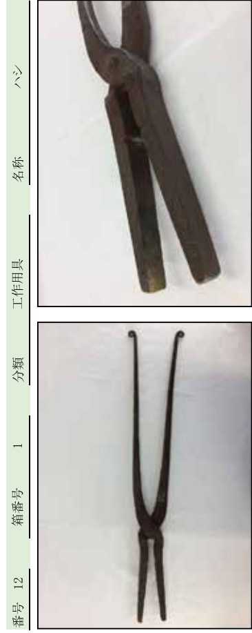
寸法 長さ67.3cm 材質 鉄製 重量 2789 g 備考 鍛冶の時に、焼けた鉄などの金属を挟む道具、「上」「オイト」の刻字あり
