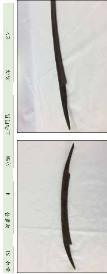
寸法 全長39.7cm、身の長さ3.3cm 材質 鉄製 重量 193 g 備考 両手で使う削り道具、竹ヒゴ等を作る道具、木柄なし
