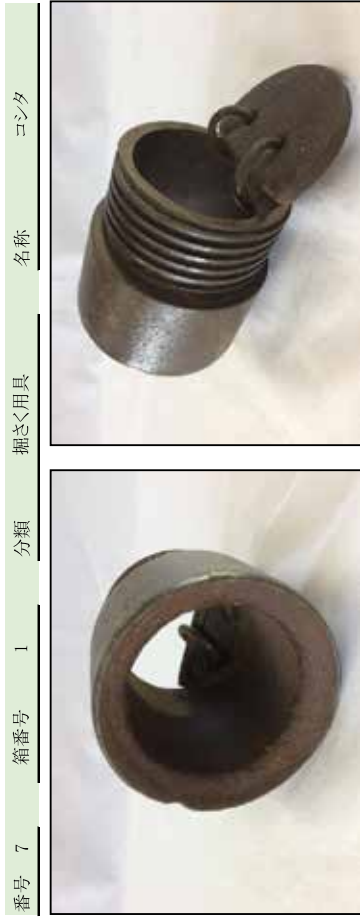
寸法 長さ7.0cm、直径6.4cm、内径4.8cm 材質 鉄製 重量 625 g 備考 ホリテッカンの先端に装着し、泥、砂を管内に取り入れる吸込弁が付く
