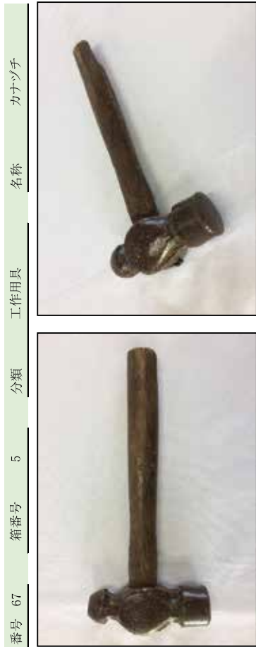
寸法 全長26.4cm、総長さ10.2cm 材質 鉄製木柄 重量 689 g 備考 ヒゴワ、カマワの固定や釘打等の作業に使用する
