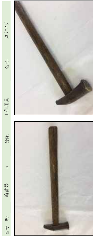
寸法 全長28.3cm、総長さ6.9cm 材質 鉄製木柄 重量 148 g 備考 ヒゴワ、カマワの固定や釘打等の作業に使用する
