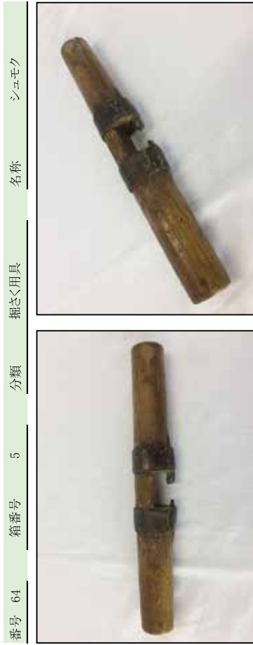
寸法 全長30.5、軸幅3.8cm 材質 木製・鉄製 重量 397 g 備考 「斉藤」焼印あり、鉄管の突き下ろしの手掛かりとなる1人用のシュモク
