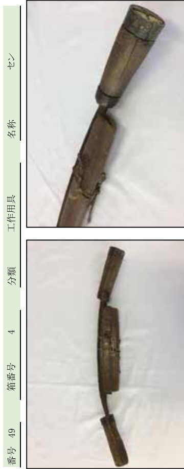
寸法 全長54.0cm 材質 鉄製木柄 重量 499 g 備考 両手で使う削り道具、竹ヒゴ等を作る道具、鞘に焼印あり
