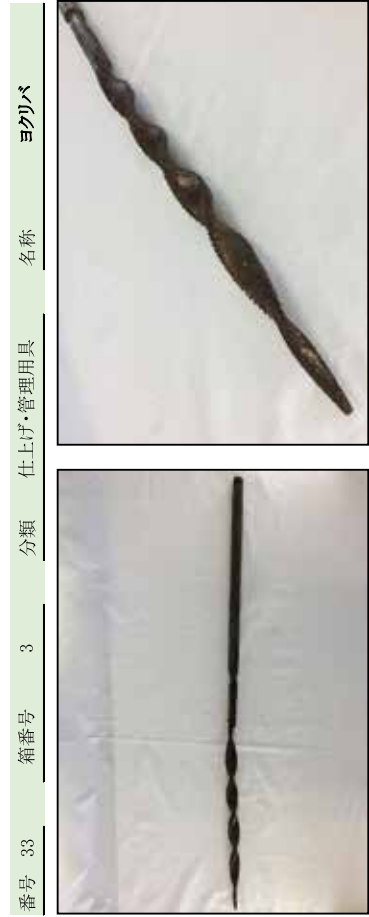
寸法 長さ87.6cm、刃部長さ46.0cm 材質 鉄製 重量 1220 g 備考 刃部と基部をリベットで結合、温泉の湯垢（スケール）を取る道具
