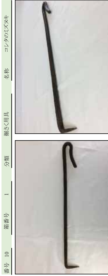
寸法 長さ45.4cm 材質 鉄製 重量 454 g 備考 スイコに入った泥や土を先端でコンタの弁を押し上げ排出させる
