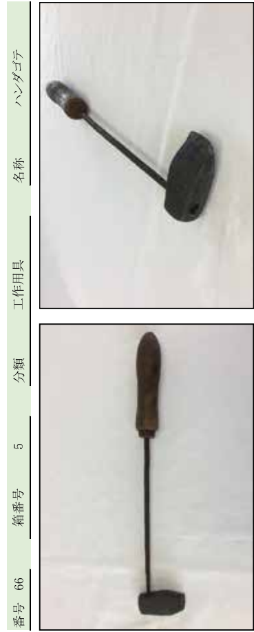
寸法 全長33.5cm 材質 木柄 重量 220 g 備考 スライコの補修時などに用いる
