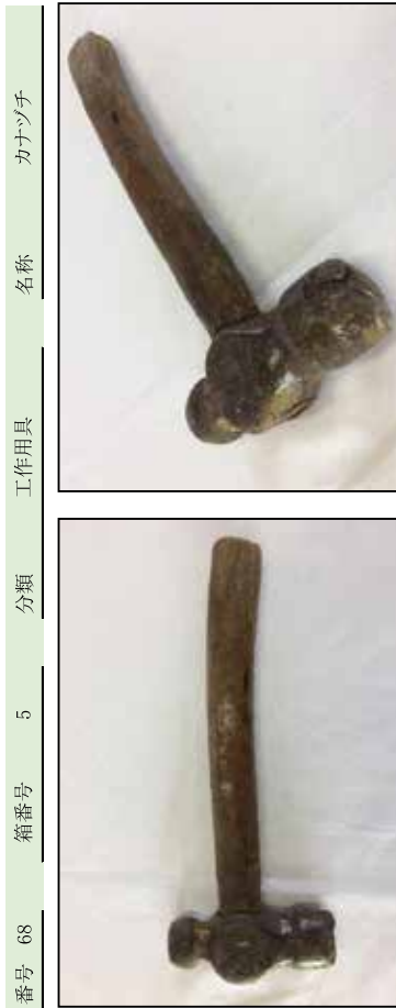
寸法 全長23.4cm、総長さ10.0cm 材質 鉄製木柄 重量 553 g 備考 ヒゴワ、カマワの固定や釘打等の作業に使用する
