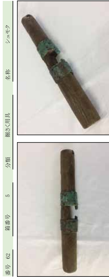
寸法 全長29.1cm、軸幅3.4cm 材質 木製・鉄製 重量 360 g 備考 「斉藤」焼印あり、鉄管の突き下ろしの手掛かりとなる1人用のシュモク
