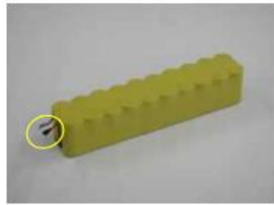
(リード線切断部を1本ずつ被覆)
