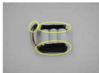
(電池端子連結部/コネクタ部の被覆)
