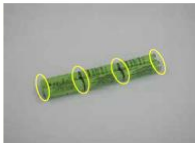
(電池端子・端子連結部露出)
