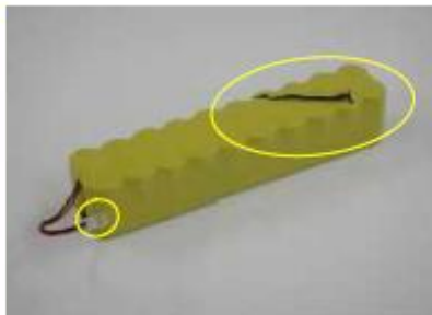
(チューブケース破損/コネクタ一部露出)
