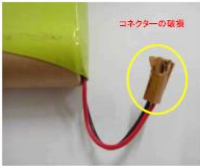
(コネクター部の破損) コネクター内でリード線同士が接触し 短絡の可能性あり
