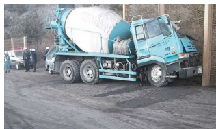
降灰によるスリップ事故 (桜島、鹿児島市提供)
